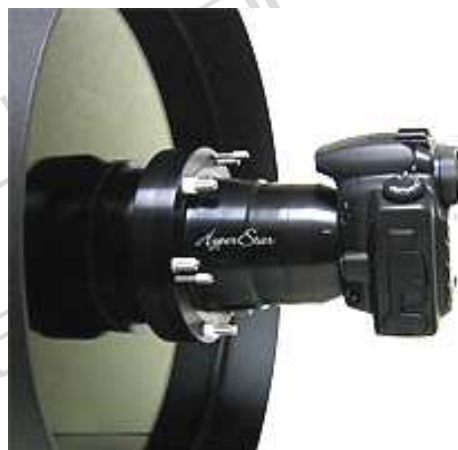
Sopra: Una reflex DSRL montata su un sistema HyperStar installato su un telescopio S-C da 11 pollici (280 mm)
